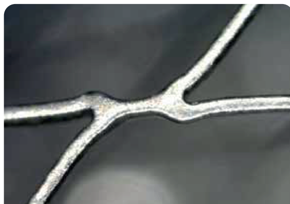
Щільний і однорідний шар з лікувальним покриттям ZENFLEX™ Pro DES
